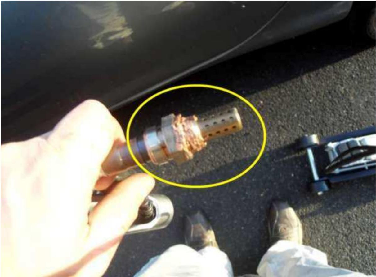
Ensuite on revisse la sonde, et on finit avec la clé dynamométrique, le cardan et la rallonge à un couple de 47nm.
